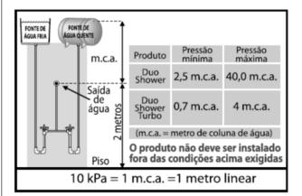
Considerando o manual acima e garantindo seu correto funcionamento, qual será a pressão da coluna de água na ducha se a as fontes de água quente e fria forem instaladas de maneira que a superfície da água nos reservatórios diste 15m lineares do piso?
